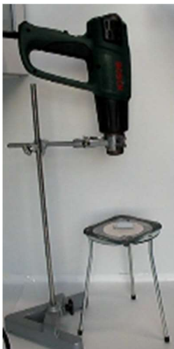
Figur 4. TiO 2 -filmen hærdes ved 450°C i 30 min under en varmepistol.
